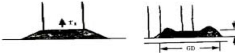
因此，非常重要的是要能够控制点胶系统，设定正确的等待延滞时间，使其等待胶完全流出针头而正确地附着于基板上，如图 6 所示。
