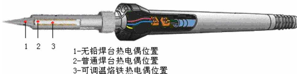
d. 提高温度监控的准确性。通过改变热电偶的安装位置，可以更加真实的获得烙铁头的工作温度，保证热能量得到快速补充。
