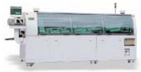
b. 发泡涂覆工艺主要使用松香基焊剂，将压缩空气通过发泡管引到容器底部，让助焊剂变为泡沫向上涌出涂覆在印制板上，其优点是设备简单，节省投资，缺点是涂覆不均匀，不能控制焊剂量，焊剂消耗量大，需要定期更换焊剂，并且印制板上有残余物污迹。此外，由于大量暴露在空气中，助焊剂中的乙醇溶剂挥发较快，使助焊剂固体含量上升，这就需要经常监视助焊剂的比重变化来控制固体含量。
